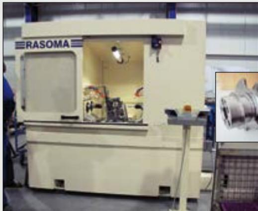
**Спецстанок для обработки двух балансировочных отверстий Ø20 на коленвалах мотоциклов, включая внетапное цекование**
