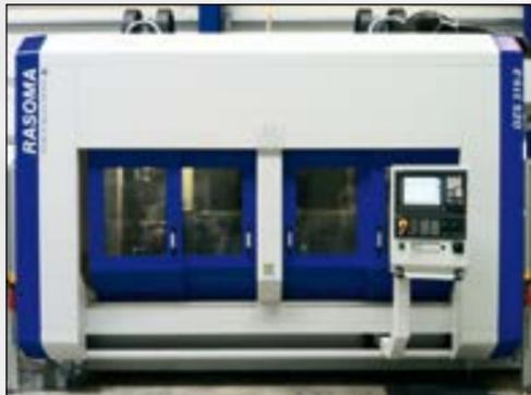
DZS 315-2 с двумя сверлильно-фрезеровальными обрабатывающими узлами и 12-ти-позиционной револьверной головкой с VDI 50
