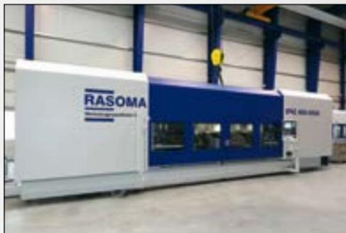
EBZ 400-4500 для торцевой обработки больших коленчатых валов длиной до 4.500 мм.
