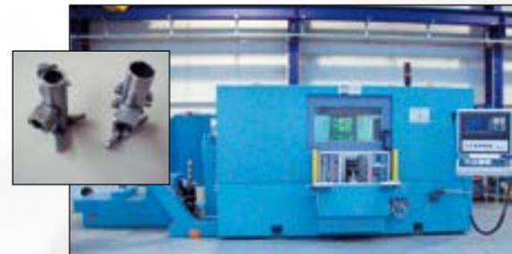
**Спецстанок для соосной, трёхсторонней обработки переключающих втулок коробок передач легковых автомобилей**
